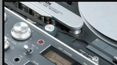
*Der Kopfträger der B 77 bot ausreichend Platz für Cutter-Arbeiten. Die praktische Schneideeinrichtung (rechts) gehörte zur Grundausrüstung der Revox.*
