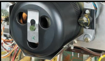
*Den hochpräzisen, verschleißfreien Tonwellenmotor übernahm die B 77 vom A-Modell. Rechts im Bild der induktiv arbeitende Drehzahlsensor.*
