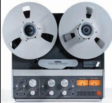
Die 1977 vorgestellte Revox B 77 verbesserte das bewährte A-77-Konzept durch ein größeres Chassis, das in der Praxis für eine günstigere Ergonomie sorgte. Zudem wurden die Laufwerkssteuerung verfeinert und der Signalweg optimiert. Die hier abgebildete Revox B 77 Mk II stammt aus dem Jahr 1987.
