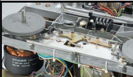
*Die kräftigen Außenläufer-Wickelmotoren der A 77 (links) erzielten auch mit schweren Metallspulen hohe Umspulgeschwindigkeiten.*
