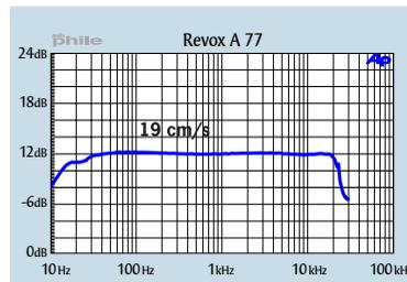
Abb. 1: Frequenzgang Hinterband
