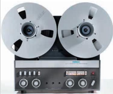
Die Revox A 77 wurde von 1967 bis 1977 gebaut. Sie war die erste voll transistorisierte Bandmaschine mit drei Motoren und drei Tonköpfen für den Heimbereich. Hervorragend waren das robuste Druckguss-Chassis und der laufruhige, präzise Tonwellenmotor. Das Bild zeigt eine Revox A 77 Mk IV von 1976.
