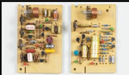
*Aufsprech- (links) und Wiedergabeverstärker der A 77 lassen sich mit neueren Bauteilen verbessern. Die weißen Block-Elkos sollten in jedem Fall ersetzt werden.*
