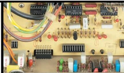
*Die Basisplatine der A 700 wirkt durch den Einsatz integrierter Schaltungen aufgeräumt. Rechts unten der Vorverstärker für den Phono-MM-Eingang.*
