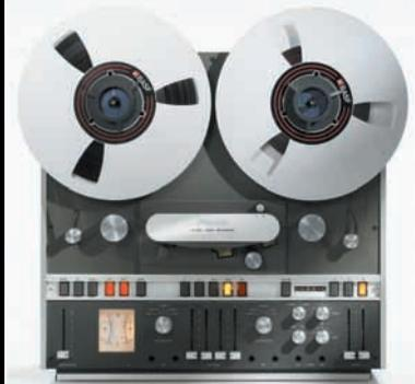
Mit einem quartzesteuerten Antrieb, der drei Bandgeschwindigkeiten und eine weit reichende Tonhöhenregelung bot, richtete sich die 1973 vorgestellte Revox A 700 an den anspruchsvollen HiFi-Fan. Mit eingebautem Stereo-Mischpult und vielfältigen Trickmöglichkeiten war sie der Traum ambitionierter Tonband-Fans.
