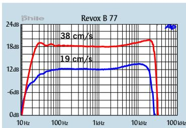
Abb. 1: Frequenzgang Hinterband
