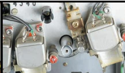
*Anstelle eines Impulskopfes zur Steuerung von Dia-Projektoren baute AUDIophile-Laborleiter Schüller bei seiner A 700 einen Viertelspur-Wiedergabekopf ein (rechts).*
