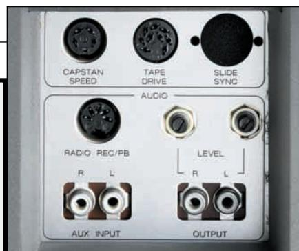
*Im Anschlusschacht der B 77 finden sich zwei Einstellregler zum Einpegeln der Ausgangsspannung. DIN-Buchsen gehörten damals noch zum Standard.*
